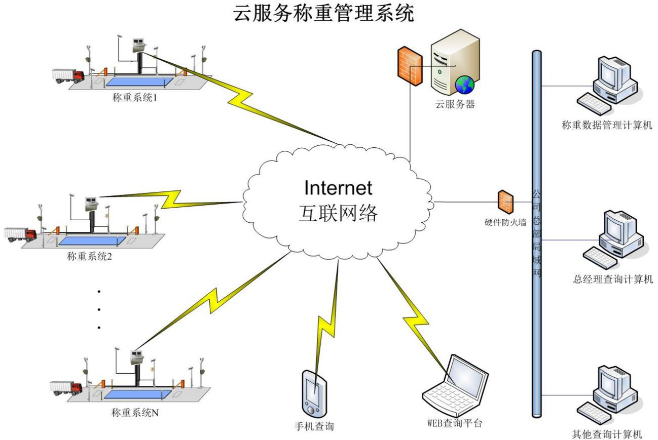
初阳云服务称重管理系统 (RSNVS) 是我公司开发的, 专门应用于集团企业称重管理系统。其采用分布式架构设计, 可通过局域网、互联网、GPRS\CDMA\3G 无线网等实现本地及远程联网, 数据实时传输, 无需固定 IP 地址。断网、带宽不足等各种网络异常情况下, 系统均能正常称重、自动保存数据, 待网络恢复后, 系统自动补传称重数据。中心管理系统软件具有数据汇总统计与报表生成功能, 中心管理系统具有互联 WEB 查询, 以及手机查询功能 (安卓和苹果手机均可)。中心管理系统可实时看到现场磅房仪表重量。(本系统全为我公司自主开发, 具
